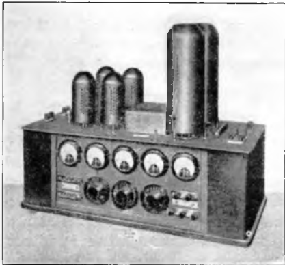
Versterker-Installatie voor geluidsfilm
